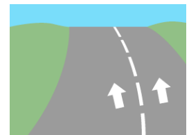
Carretera de un solo sentido con línea discontinua blanca: se permite adelantar
